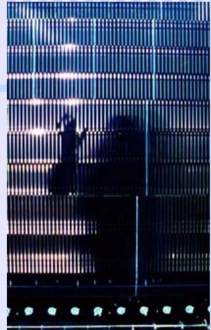
Схема расположения ячеек Tile-калориметра. Внизу - центральная часть. Наверху - концевые (end-cap)
