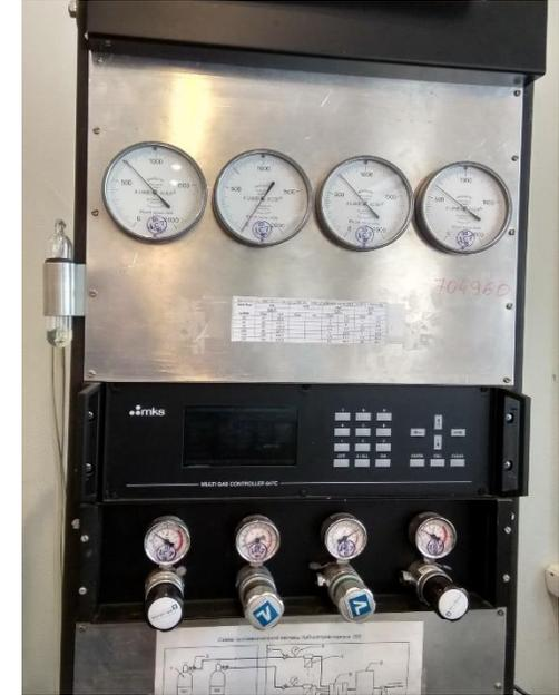
Газовая система для продувки MRPC смесью:  $C_2H_2F_4 + SF_6 + i-C_4H_{10}$  (90/5/5)
