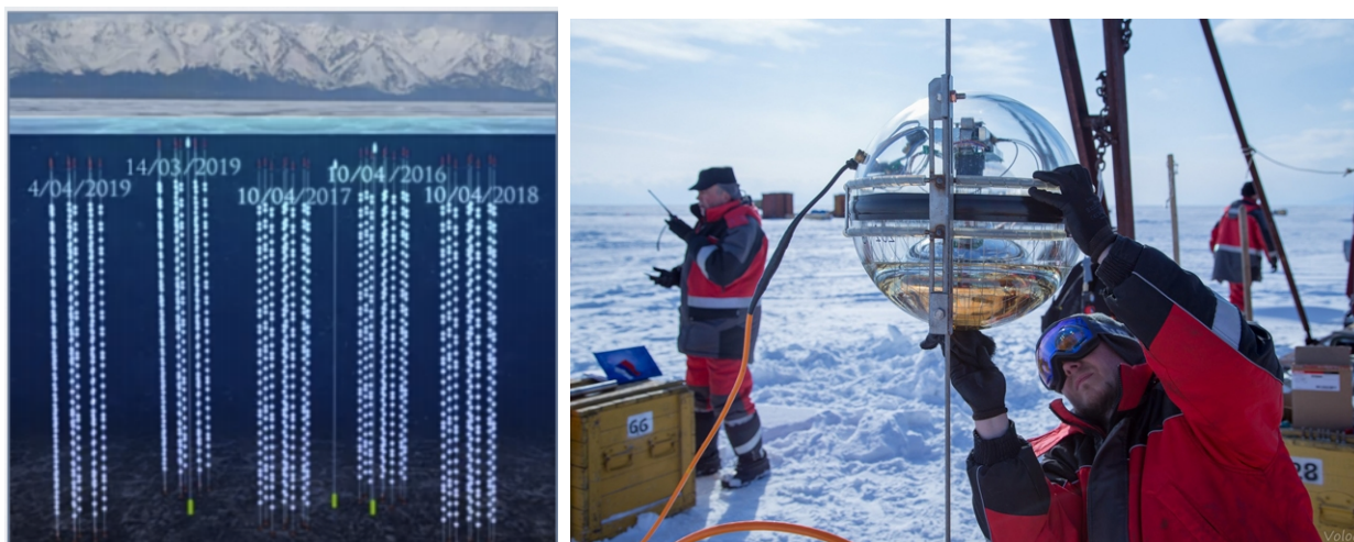
Рис. 4.4. Слева: Пять кластеров телескопа Baikal-GVD; Справа: фотоумножитель, используемый экспериментом Baikal-GVD
