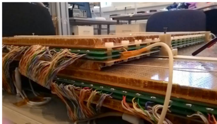
Рис. 4: Схема mRPC для детектора ToF-400 и реальное изображение mRPC.
