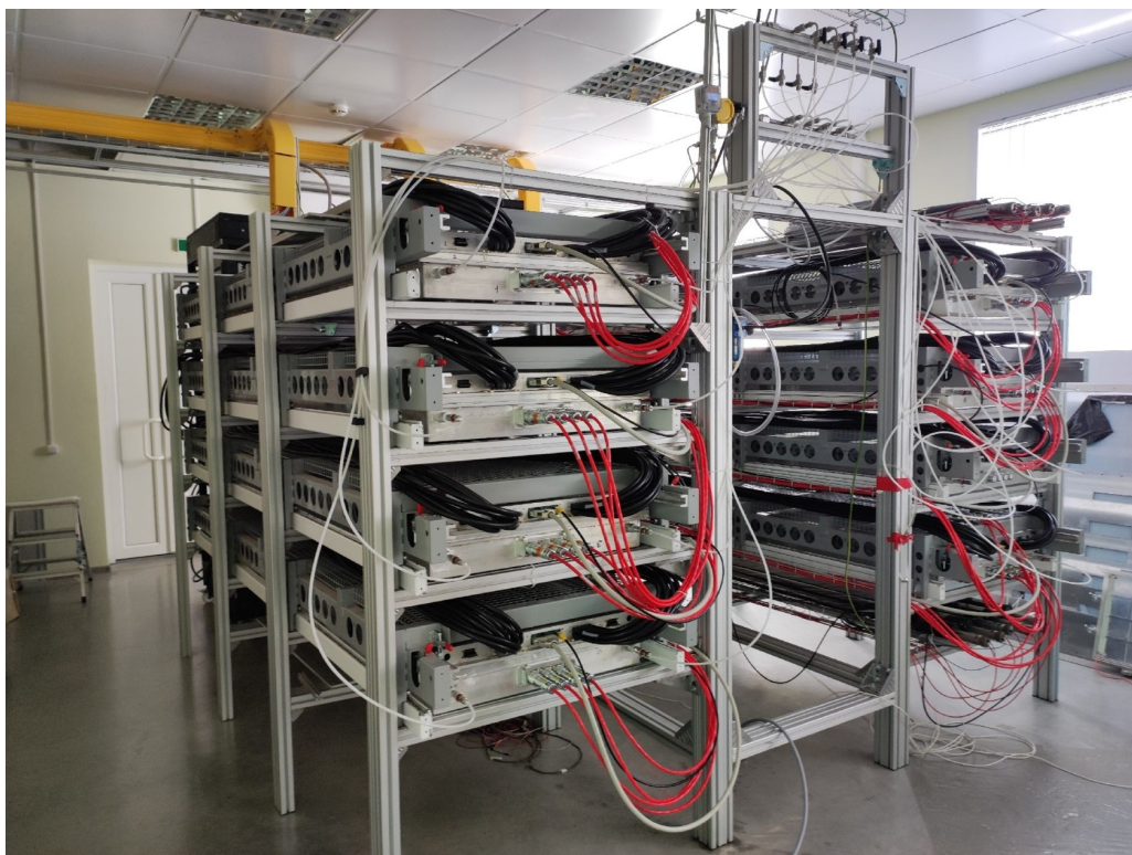
Рис. 5: Стенд тестирования модулей на космическом излучении.
