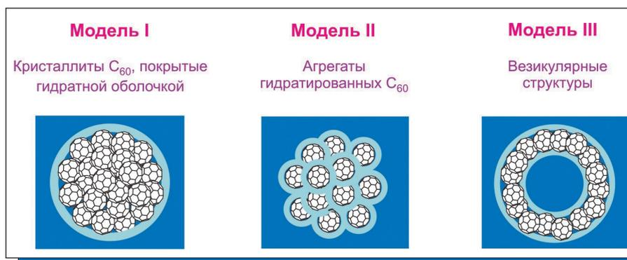
**РИСУНОК 3** | Модели коллоидных частиц в водных растворах фуллеренов. Синим цветом обозначена объемная вода, голубым — водная оболочка (поверхностная вода)
