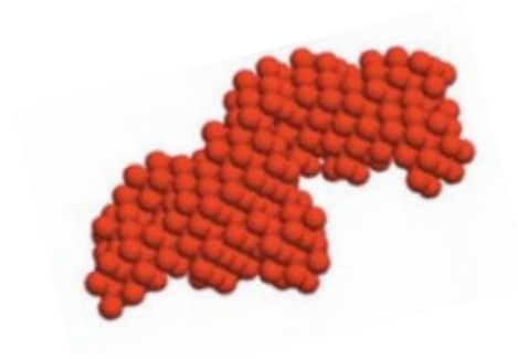
Рис.2.21. Пример тела со сложной формой, заполненного плотноупакованными шариками одинакового радиуса R в методе шариков по расчету форм-фактора согласно формуле (2.31).
