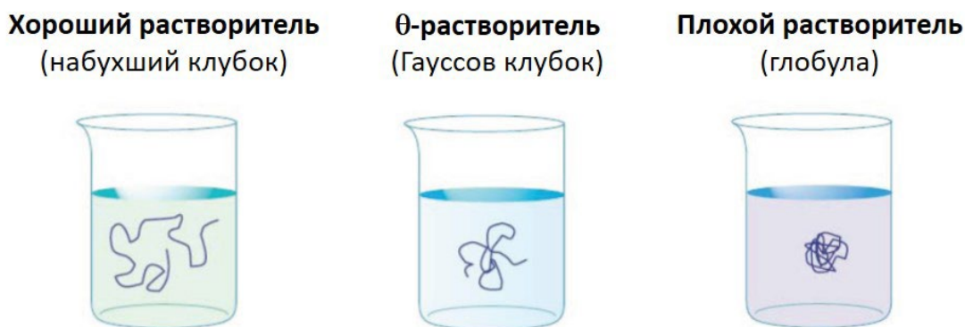
Рис.4.9. Классификация полимерных цепей в разбавленных растворах по характеру взаимодействия с растворителем.
