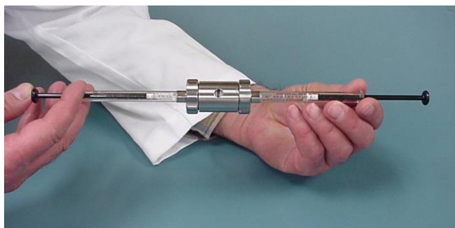
Рис. 2.4. Продавливание раствора через фильтр экструдера Liposofast Basic . Многослойные везикулы из левого шприца продавливаются через нанопоры фильтра и собираются в правом шприце.
