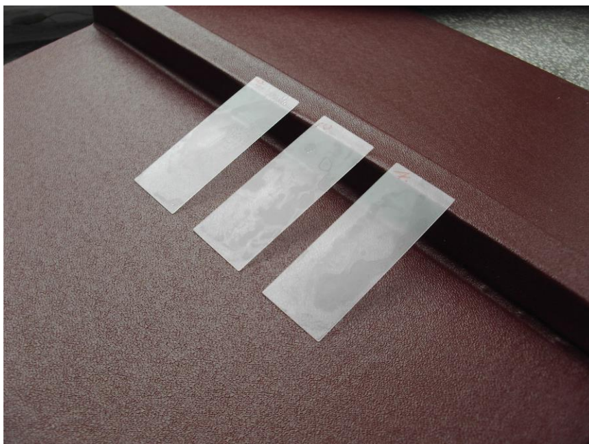
Рис. 2.6. Образцы модельных мембран липидной матрицы SC. Многослойная липидная мембрана с составом церамид6/ холестерин/ пальмитиновая кислота/ сульфат холестерина на кварцевых подложках.
