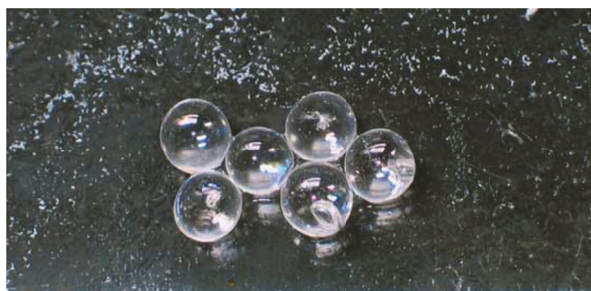
Рис. 10.5.3. Шарики (гранулы, \varnothing 3.5 мм) из смеси мезитилена с m -ксилолом, используемые в качестве рабочего вещества в холодных замедлителях на ИБР-2.
